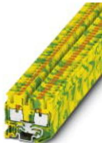
Заземляющая клемма Mini, тип подключения: Зажимы Push-in, количество точек подсоединения: 2, сечение: 0,14 мм<sup>2</sup> - 4 мм<sup>2</sup>, AWG: 26 - 12, ширина: 5,2 мм, высота: 32,1 мм, цвет: желто-зел., тип монтажа: NS 15
