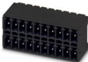
Корпусная часть для печатных плат, номинальный ток: 8 A, расчетное напряжение (III/2): 160 В, полюсов: 17, размер шага: 3,5 мм, цвет: черный, поверхность контакта: олово, монтаж: THR пайка, Длина выводов составляет 2,6 мм. Информация для пользователя и рекомендации по проектированию процесса технологии сквозного печатного монтажа находится на сайте: "Загрузка"
