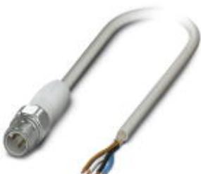
Кабель для датчика / исполнительного элемента, 4-полюсн., PP-EPDM без галогенов, серый RAL 7035, экранирован., Штекеры прямое M12, А-кодирование, к свободный конец, длина кабеля: 10 м, Гигиеничный дизайн, с накатанной гайкой из легированной стали
