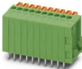
Клеммы для печатной платы, номинальный ток: 6 А, номинальное напряжение: 160 В, размер шага: 2,54 мм, полюсов: 26, тип подключения: Пружинные зажимы Push-in, монтаж: Пайка волной припоя, направление подключения, проводник/печатная плата: 90°, цвет: зеленый. Возможна установка в ряд модулей с различным количеством полюсов (контактов)!
