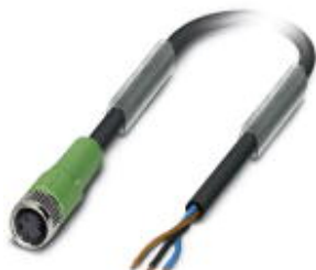
Кабель для датчика / исполнительного элемента, 3-полюсн., ПВХ, черный RAL 9005, свободный конец, к Гнездо прямое M8, длина кабеля: 5 м
