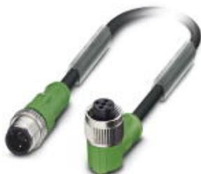
Кабель для датчика / исполнительного элемента, 3-полюсн., PUR без галогенов, отвержденный излучением, оранжевый RAL 2003, Штекеры прямое M12, A-кодирование, к Гнездо угловой M12, A-кодирование, длина кабеля: 3 м
