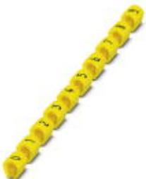
Маркировочные кольца для проводников, желтый, горизонтально: Нумерация, тип монтажа: нанизывание, диапазон диаметра кабеля: 1,4 ... 2,5 мм, размер маркировочного поля: 3,2 x 2,6 мм
