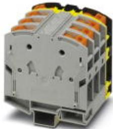
Клемма для высокого тока, блокированный, номинальное напряжение: 1000 В AC / 1500 В DC, номинальный ток: 150 А, тип подключения: Зажим Power-Turn, количество точек подсоединения: 8, полюсов: 4, сечение: 10 мм<sup>2</sup> - 70 мм<sup>2</sup>, AWG: 8 - 2/0, ширина: 80 мм, цвет: серый/черно-желтый, тип монтажа: NS 35/15
