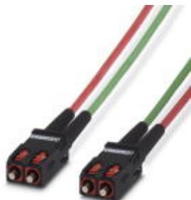
Подготовленный оптоволоконный кабель, кабель Break-Out, волокно PCF 200/230 мкм, SC-RJ/IP20 на SC-RJ/IP20, для прокладки внутри электрошкафов, длина: 1 м
