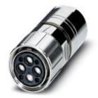
Кабельный соединитель, прямой, Винтовой зажим, М58, полюсов: 2+3+PE, тип контактов: Розетка, Обжим, экранирован.: есть, диапазон диаметра кабеля: 17 мм ... 25 мм
