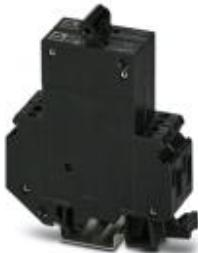
Автоматические выключатели с тепловыми и электромагнитными расцепителями, 2-полюсные, полуинертного типа, 1 замыкающий контакт и 1 размыкающий контакт, с универсальными монтажными ножками для установки на NS 32 или NS 35
