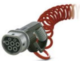
Зарядный кабель переменного тока с автомобильным зарядным штекером, без разъема, с защитным колпачком, Designline 1, Тип 2, МЭК 62196-2, 20 А / 250 В (AC), тип конструкции D-Line, кабель: 4 м, красный, спираль, поверхность сопряжения: серый, область захвата: серый
