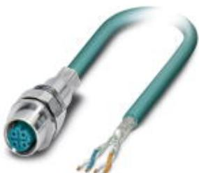
Готовый Ethernet-кабель, CAT5e, экранированный, 2 пары, гибкий AWG 26 (7-проводочный), RAL 5021 (цвет морской воды), встраиваемая розетка M12, монтаж с передней части стенки / резьбовое крепление с M16, другой конец - без разъема, прямая разводка, длина 2 м
