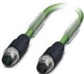
Системный кабель шины, PROFINET CAT5 (100 Мбит/с), 4-полюсн., ПВХ/ПВХ, зеленый RAL 6018, экранирован., Штекеры прямое M12, с механическим ключом D-типа, к Штекеры прямое M12, с механическим ключом D-типа, длина кабеля: 1 м
