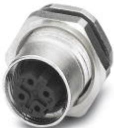
Встраиваемая розетка шинной системы, Ethernet, 4-конт., M12, с механическим ключом D-типа, монтаж с задней части стенки / резьба Pg9, с прямыми выводами под пайку
