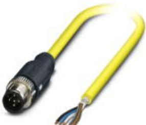
Кабель для датчика / исполнительного элемента, 5-полюсн., ПВХ, желтый, экранирован., Штекеры прямое M12 SPEEDCON, А-кодирование, к свободный конец, длина кабеля: 2 м
