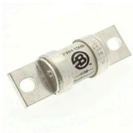
Предохранитель, высокая скорость, 50 А, перем. ток 500 В, пост. ток (DC) 500 В, 24 x 91 мм, aR, UL
