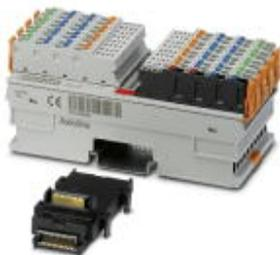
Axioline F XC, Модуль цифрового вывода, Цифровые выходы: 16, 24 В DC, 500 мА, способ подключения: 3-проводная схема, Исполнение для тяжелых условий эксплуатации, скорость передачи данных в локальной шине: 100 Мбит/с, степень защиты: IP20, с цокольным модулем шины и штекерами Axioline F
