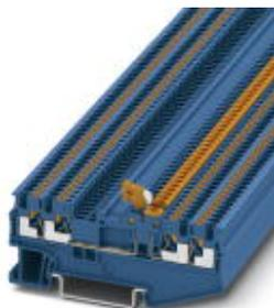
Клеммы с ножевыми размыкателями, номинальное напряжение: 400 В, номинальный ток: 10 А, тип подключения: Зажимы Push-in, сечение: 0,14 мм<sup>2</sup> - 1,5 мм<sup>2</sup>, AWG: 26 - 14, длина: 76,9 мм, ширина: 3,5 мм, цвет: синий, монтаж: NS 35/7,5, NS 35/15, номинальное напряжение: 400 В
