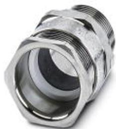
Кабельный ввод, материал резьбового соединения: латунь, никелированный, применение: Ex, наружный диаметр кабеля 23,5 мм ... 32,2 мм, экранировка: нет, резьба соединительной части: M40 x 1,5, цвет: серебристый
