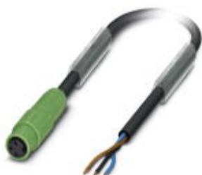
Кабель для датчика / исполнительного элемента, 3-полюсн., PUR без галогенов, темно-серый RAL 7021, свободный конец, к Гнездо прямое M8 Snap-In, длина кабеля: 2 м
