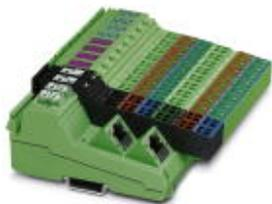
Inline, Block IO, Ethernet, Гнездо RJ45, Цифровые входы: 32, 24 В DC, способ подключения: 3-проводная схема, Цифровые выходы: 16, 24 В DC, 500 мА, способ подключения: 2-проводная схема, степень защиты: IP20, вкл. штекер Inline и поле
