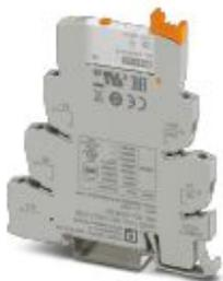
PLC-INTERFACE для функций ввода, состоит из основной клеммы PLC-BSC.../SEN с винтовым зажимом и вставным мини-реле с многосл. золотым контактом и ручным управлением, 1 замыкающий контакт, входное напряжение 24 В пост. тока
