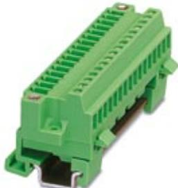
Штекер для установки на монтажную рейку, номинальный ток: 8 А, расчетное напряжение (III/2): 160 В, полюсов: 13, размер шага: 3,81 мм, тип подключения: Винтовой зажим с натяжной гильзой, цвет: зеленый, поверхность контакта: олово, монтаж: Монтажная рейка
