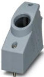
Сальниковый корпус из пластика, с метрическим кабельным отводом, крепежные винты с цилиндрической головкой, конструктивная форма: VC2, кабельный разъем: M25
