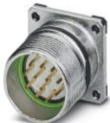
Приборный соединитель, передняя часть стенки, прямой, экранирован.: есть, Винтовой зажим, M23, полюсов: 8+1, тип контактов: Штифт, Подключение пайкой, Плоское уплотнение, 4x Ø2,7, размер фланца: 25 мм x 25 мм
