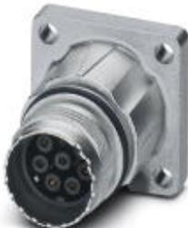
Аппаратн. соединитель, передняя стенка, прямой, для стандартной блокировки и SPEEDCON, M17, полюсов: 5+3+PE, тип контактов: Штифт, Обжим, Аксиальное уплотнительное кольцо, 4x Ø 3,2, экранирован.: есть, размер фланца: 25,75 мм x 25,75 мм
