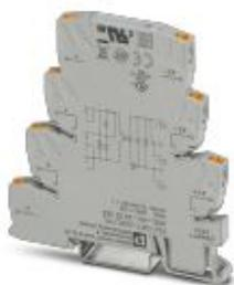
PLC-INTERFACE для сигнала TTL, состоит из основной клеммы PLC-O.../TTL с зажимом push-in и встроенным полупроводниковым реле, для монтажной рейки NS 35/7,5, 1 замыкающий контакт, вход: 24 В DC, выход: TTL (5 В DC)
