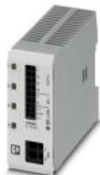
Многоканальный электронный автоматический выключатель с интерфейсом IO-Link для защиты четырех потребителей сети 24 В DC от перегрузки и короткого замыкания. С электронной блокировкой настроенных номинальных токов. Для установки на несущих DIN-рейках.
