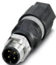
Соединитель для датчика/исполнительного устройства, Универсальный, 4-полюсн., Штекеры прямое M12, А-кодирование, Клеммы с ножевыми контактами, материал накатанной гайки: Нержавеющая сталь 1.4404, наружный диаметр кабеля 4 мм ... 8 мм
