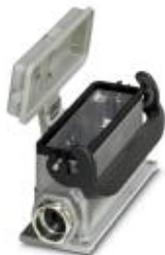
Приборный корпус с одной защелкой, высота 67 мм, с резьбовым соединением, 2x Pg21, с защитной крышкой
