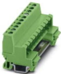
Штекер для установки на монтажную рейку, номинальный ток: 12 А, полюсов: 10, размер шага: 5,08 мм, тип подключения: Винтовой зажим с натяжной гильзой, цвет: зеленый, поверхность контакта: Золото, монтаж: Пайка волной припоя
