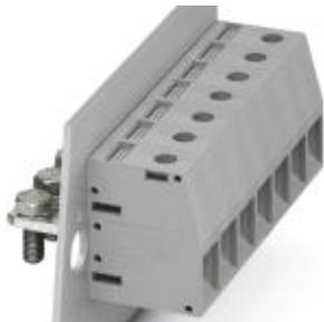
Проходная клемма, тип подключения: Винтовые зажимы, Подсоединение кабельного наконечника, полюсов: 1, ток нагрузки: 150 А, сечение: 16 мм<sup>2</sup> - 50 мм<sup>2</sup>, AWG 6 - 1/0, угол между направлениями подключения провода и установки разъема: 0°, ширина: 18,8 мм, цвет: серый
