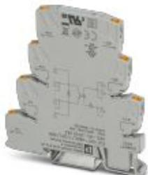
PLC-INTERFACE для ж/д транспорта, состоит из основной клеммы с зажимом push-in и встроенного миниатюрного полупроводникового реле, диапазон:  $0,7 \times U_N$  до  $1,25 \times U_N$ , диапазон температуры:  $-25^\circ\text{C}$  до  $+70^\circ\text{C}$ , 1 замыкающий контакт, вход: 48 В DC, выход: 12-140 В DC/3 А
