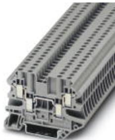
Проходные клеммы, номинальное напряжение: 500 В, номинальный ток: 24 А, тип подключения: Винтовые зажимы, количество точек подсоединения: 4, сечение: 0,14 мм<sup>2</sup> - 4 мм<sup>2</sup>, AWG: 26 - 12, ширина: 5,2 мм, высота: 46,9 мм, цвет: серый, тип монтажа: NS 35/7,5, NS 35/15
