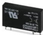
Вставное миниатюрное полупроводниковое реле, силовое полупроводниковое реле, 1 замыкающий контакт, вход: 24 В DC, выход: 3 ... 33 В DC/3 А
