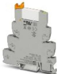
PLC-INTERFACE, состоит из основной клеммы PLC-BSC.../21 с винтовым зажимом и вставным миниатюрным реле с многосл. золотым контактом, для монтажной рейки NS 35/7,5, 1 переключающий контакт, входное напряжение 220 В DC
