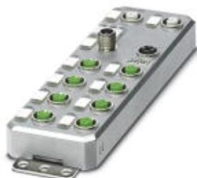
Устройство Axioline E-Sercos в металлическом корпусе с 8 портами IO-Link и 4 цифровыми входами, 24 В DC, разъемы для быстрого подключения M12
