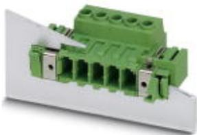
Проходной штекер, номинальный ток: 41 А, расчетное напряжение (III/2): 1000 В, полюсов: 9, размер шага: 7,62 мм, тип подключения: Винтовой зажим с натяжной гильзой, цвет: зеленый, поверхность контакта: олово
