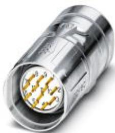
Кабельный соединитель, прямой, экранирован.: есть, Крепление SPEEDCON, M23, Полюсов: 17, тип контактов: Штифт, Обжим, диапазон диаметра кабеля: 10 мм ... 14,5 мм
