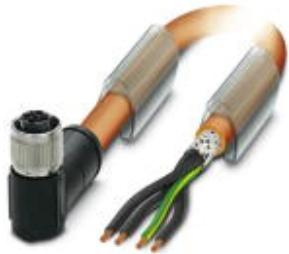
Силовой кабель, 4-полюсн., PUR без галогенов, оранжевый RAL 2003, экранирован. (Advanced Shielding Technology), свободный конец, к Гнездо угловой M12, S-кодирование, длина кабеля: 1,5 м, для переменного тока до 12 А / 690 В
