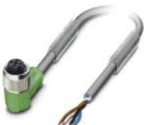
Кабель для датчика / исполнительного элемента, 4-полюсн., PUR без галогенов, стойкий к воздействию искр при сварке, повышенная гибкость, серый RAL 7001, свободный конец, к Гнездо угловой M12, А-кодирование, длина кабеля: 5 м, для использования на роботах и тяговых цепях
