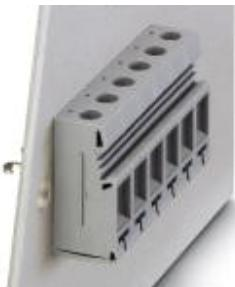
Проходная клемма, тип подключения: Винтовые зажимы, Подключение пайкой, полюсов: 1, ток нагрузки: 57 A, сечение: 0,2 mm<sup>2</sup> - 10 mm<sup>2</sup>, AWG 24 - 8, угол между направлениями подключения провода и установки разъема: 0 °, ширина: 10 mm, цвет: серый
