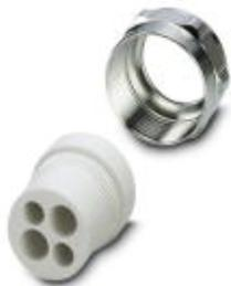
Составной резьбовой соединительный элемент Pg21, металлический, в комплекте с резиновым уплотнением с несколькими отверстиями (2x6 мм/2x8 мм) и прижимной винтовой деталью, для переходных муфт сальника VC-M-KV-PG21...
