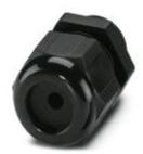
Пластмассовый кабельный ввод со шлицевым уплотнением, для штекерных соединителей с уже оконцованным кабелем, IP66, соединительная резьба M25, внутренний диаметр: 18,2 мм
