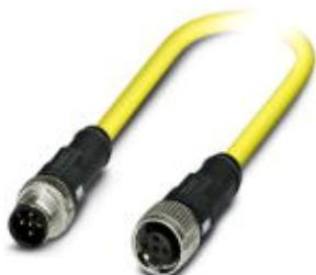
Кабель для датчика / исполнительного элемента, 5-полюсн., ПВХ, желтый, Штекеры прямое M12 SPEEDCON, А-кодирование, к Гнездо прямое M12 SPEEDCON, А-кодирование, длина кабеля: 1,5 м
