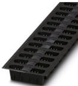
Штыревой разъем, номинальный ток: 8 А, расчетное напряжение (III/2): 250 В, полюсов: 8, размер шага: 3,5 мм, цвет: черный, поверхность контакта: олово, монтаж: THR пайка, Максимальный ток зависит от используемого разъема. Учитывается самой низкое из значений тока для разъема и штыревой планки. Штыревая колодка изготавливается из стойкой к высокой температуре пластмассы и, таким образом, допускают монтаж пайкой оплавлением припоя.
