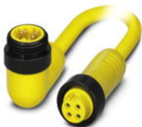
Силовой кабель, 4-полюсн., ПВХ, желтый, Штекеры угловой 7/8"-16UNF, А - стандарт, к Гнездо прямое 7/8"-16UNF, длина кабеля: 1 м
