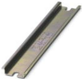
Несущая рейка без перфорации, ширина: 35 мм, высота: 7,5 мм, материал: Сталь, оцинкован., пассивирован., длина: 160 мм, специально для полых коробок подключения из полиэфира от РхС, цвет: серебристый
