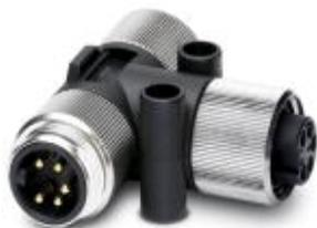
T-распределитель, 5-полюсн., неэкранированный, Штекеры прямое 7/8"-16UNF, к Гнездо прямое 7/8"-16UNF и Гнездо прямое 7/8"-16UNF, параллельный распределитель
